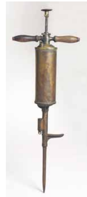
► Iniettore di bisolfuro di carbonio
