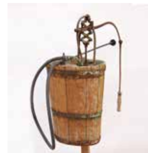
► Pompa a spalla con serbatoio in legno (SP) e in metallo
