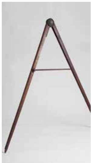
▶ Pertica o compasso in "piedi veneziani". Una volta aperto e fatto ruotare, puntato nel terreno su uno dei due perni, misurava i multipli dell'apertura. (Erpac)
