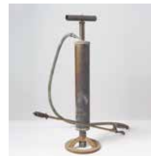
► Pompa manuale a stantuffo per piccoli vigneti
