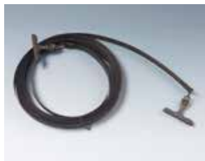
▶ Doppio decametro a nastro misurava fino a 20 metri. Sono indicate le sottomisure al mezzo metro e metro. (Erpac)
