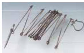
▶ Pentametro a catena: catena di 5 metri formata da moduli di 20 cm. Si poteva usare anche come compasso, puntando al centro il picchetto. (Erpac)
