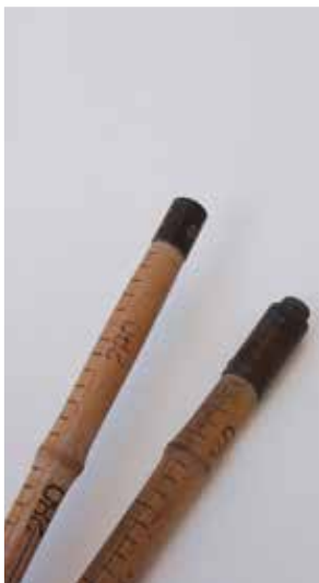
▶ Triplo metro composto da due moduli da 1,5 metri ciascuno, che assemblati raggiungono la lunghezza di 3 metri. È in canna di bambù. (SP)
